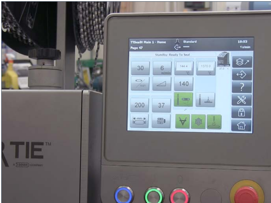
Mandos desde un solo punto para acceso sencillo a los procesos de sellado y clipeado.
