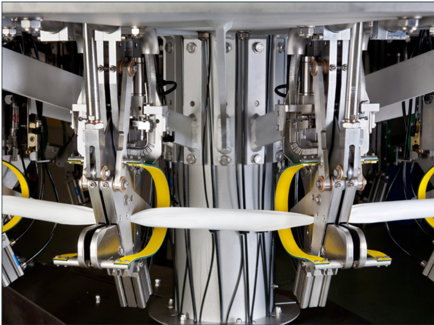
El Rota-Clip puede elaborar más de 330 envases individuales sellados y cerrados por minuto.
