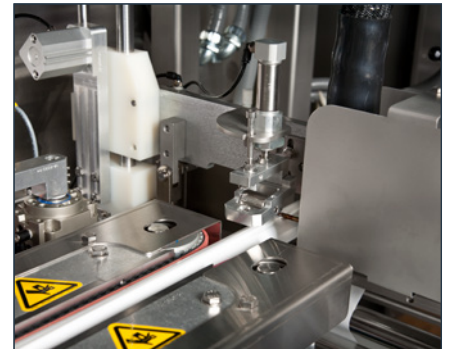
El accionamiento continuado de la lámina conduce el tubo por debajo de la unidad de sellado, la cual realiza el sellado térmico o adhesivo.
