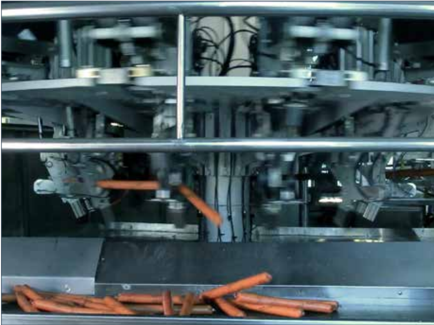
La máquina Rota-Clip en la producción de alta velocidad de cartuchos de explosivos comerciales.
